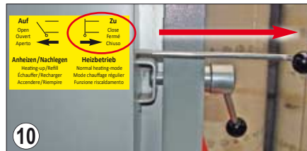
10 Set the draft bar to position „close“ / „normal heating mode“.
